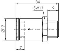
Eingangsdruck max. 15 bar
